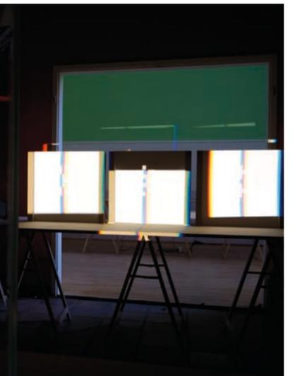
Lehre Newtons. Denn das von der linken Säule zurückstrahlende rote Licht wird beim Rückweg durchs Prisma weniger weit vom Weg abgelenkt als sein blaues Gegenstück (von der rechten Säule); auf dem prismatischen Rückweg wird die Trennung der beiden Farben rückgängig gemacht. Sie kommen in *einem* schmalen Streifen zusammen und bilden ein zart leuchtendes Pfirsichblüt – Pink, wenn Sie so wollen; ein
